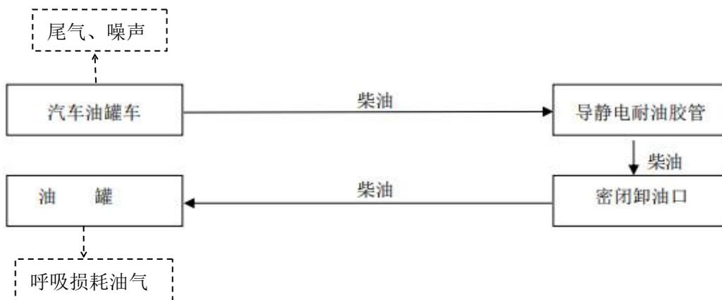
汽油加油工艺流程及排污节点图：
